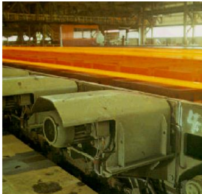
Рис.1. Приводные системы «Getriebebau NORD» в сталепрокатном производстве.
