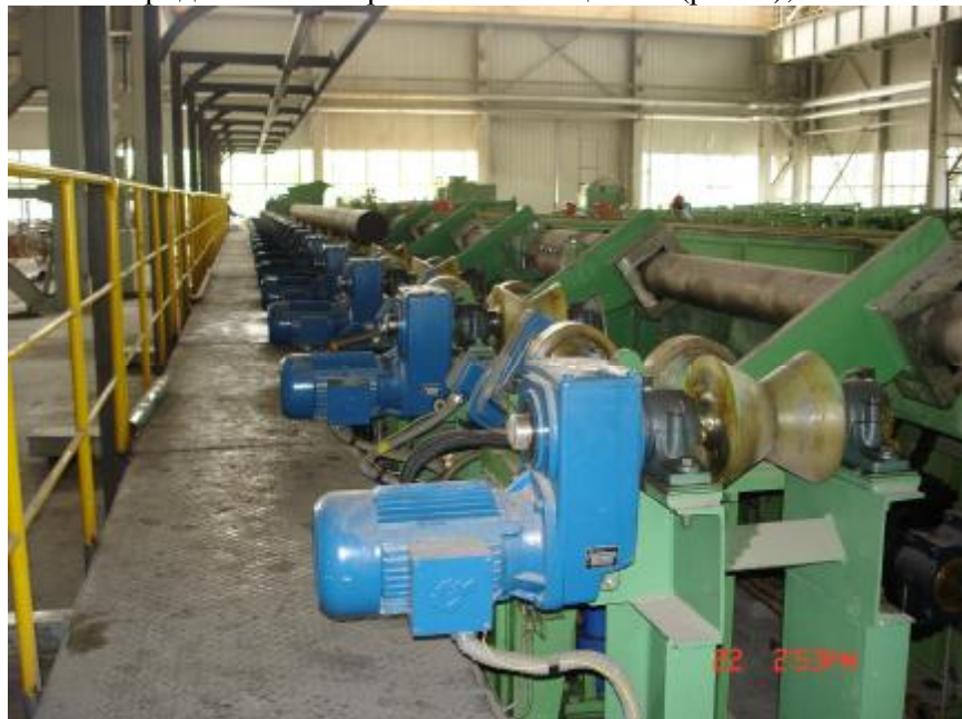
Рис.2. Привод рольганга – мотор-редуктор фирмы «Getriebebau NORD».
